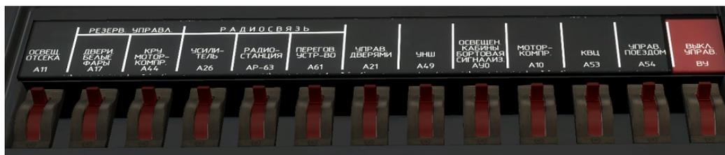
9. Включает тумблеры: "Фары вкл.", "Дешифратор 2/6" (проверить), "АЛС" (проверить), "УНЧ", "Контроль 1", "Контроль 2", "Радио-информатор", "Радиостанция":
