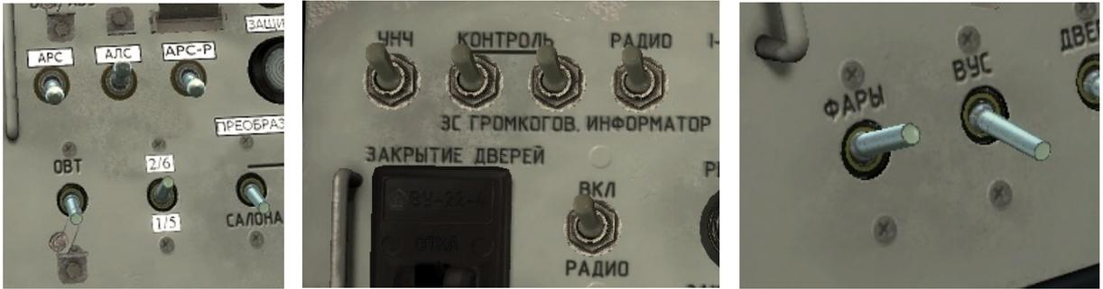
22. Контролирует тумблер "ВУД" (управление дверьми) в верхнем положении:
