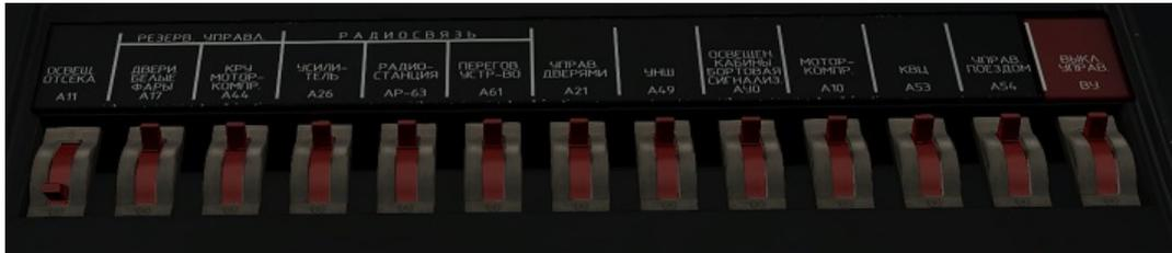
21. Включает тумблеры: "Фары вкл.", "УНЧ", "Контроль 1", "Контроль 2", "Радиоинформатор", "Радиостанция", "Освещение кабины" (по желанию), "Освещение приборов" (по желанию), "Дешифратор 2/6" (проверить), "АЛС" (проверить):
