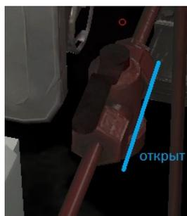
12. Контролирует тумблер "ВУД" (управление дверьми) в верхнем положении:
