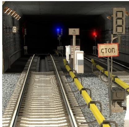
40. Останавливается у светофора "Е-1"/"Е-2" не зависимо от его показания у знака "СТОП" краном машиниста установкой его в 4 положение, подает сигнал "3 коротких" тайфуном, закрывает боковую дверь в кабину. Контролирует фактическое включение тумблеров "Мотор-компрессор", "БПСН":
